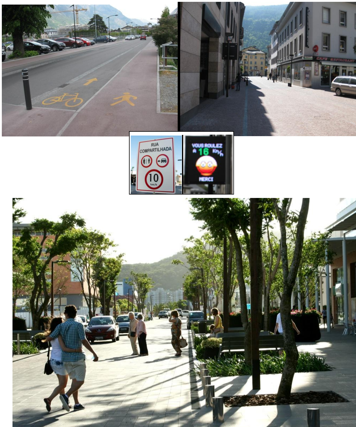
Figura 274 e 275 (no alto) – Vias compartilhadas com piso diferenciado (desenho, cor, material) para pedestres, ciclistas e veículos, em Martigny (Suíça). Fotos da autora tomadas em 26/04/2014.
