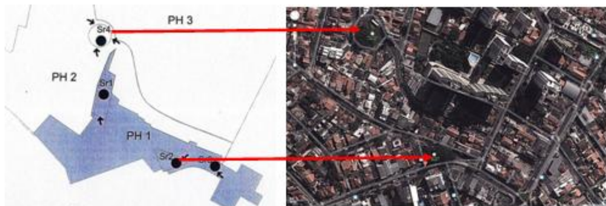
Figura 282 – Setores hidráulicos de retenção SR-1, SR-2 e SR-3 em PH-1 (LIMA, 2004). Relação do esquema com foto de satélite obtida no Google em 2014.
